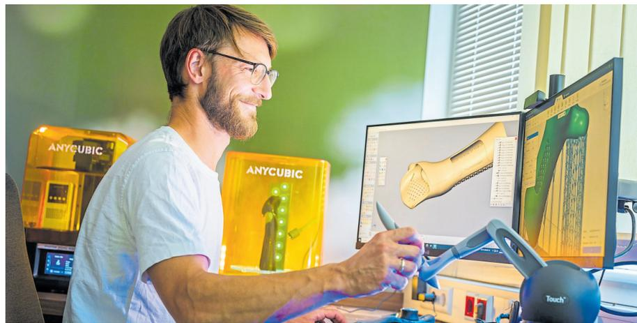
Orthopädietechniker und Produktgestalter Sebastian Zedel erstellt und passt am Computer Konstruktionspläne für eine Handorthese an. Die Datei ist die Grundlage für einen 3D-Druck, der das medizinische Hilfsmittel innerhalb kürzester Zeit entstehen lässt.
