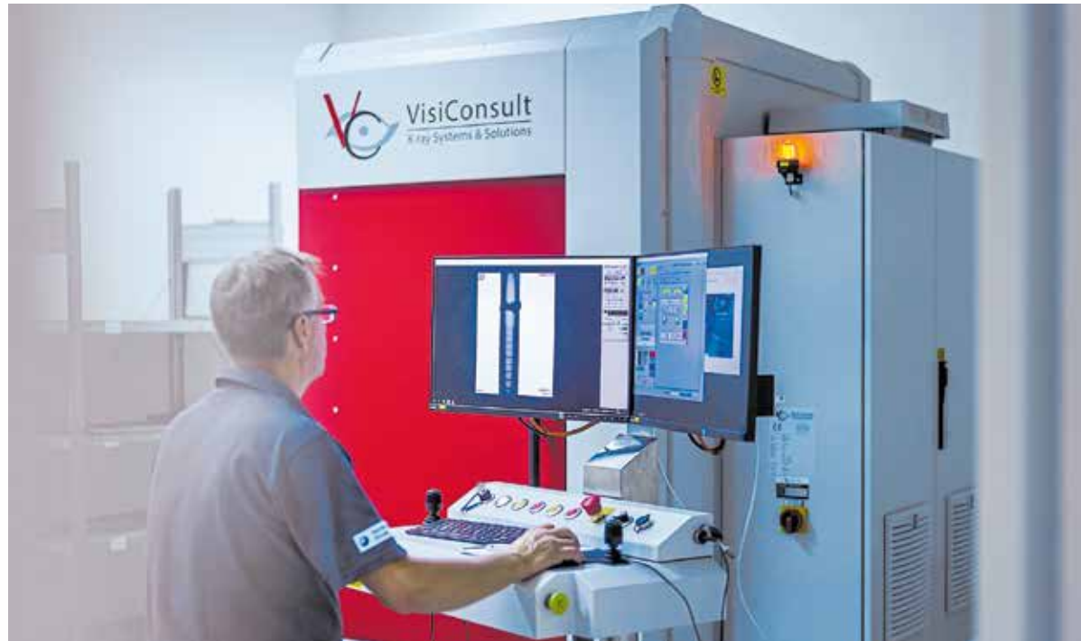
Im Prüflabor der Schweißtechnischen Lehranstalt werden zerstörungsfreie – wie hier die Röntgenprüfung –, aber auch zerstörende Werkstoffprüfungen durchgeführt.
